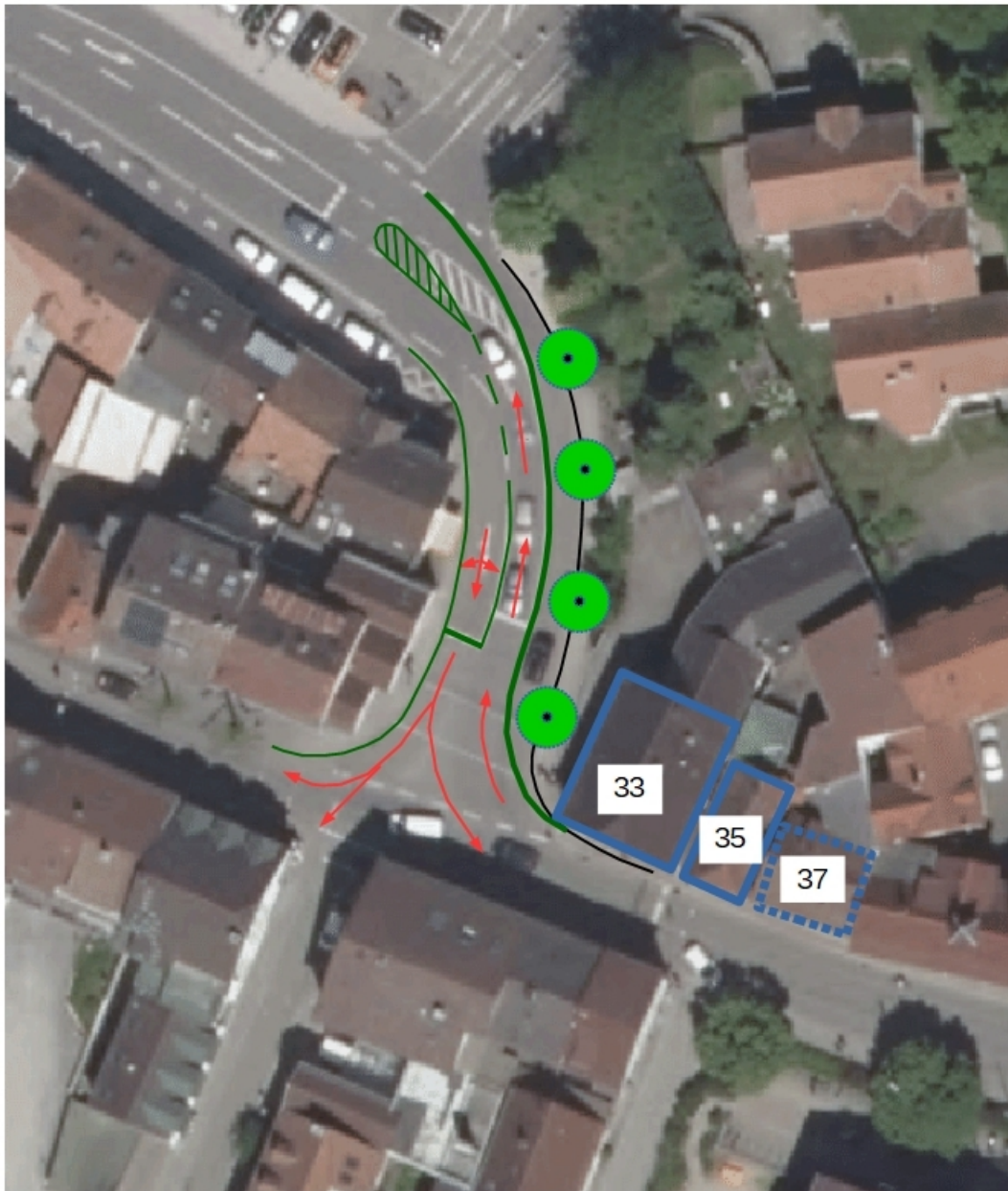
Abb. 1 Umbau Einmündung Sporgasse unter Erhaltung der Häuser Weißhofer Str. 33, 35 und 37
